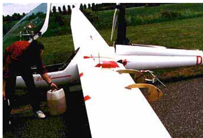
DG-800 の翼型の抵抗を計測する
