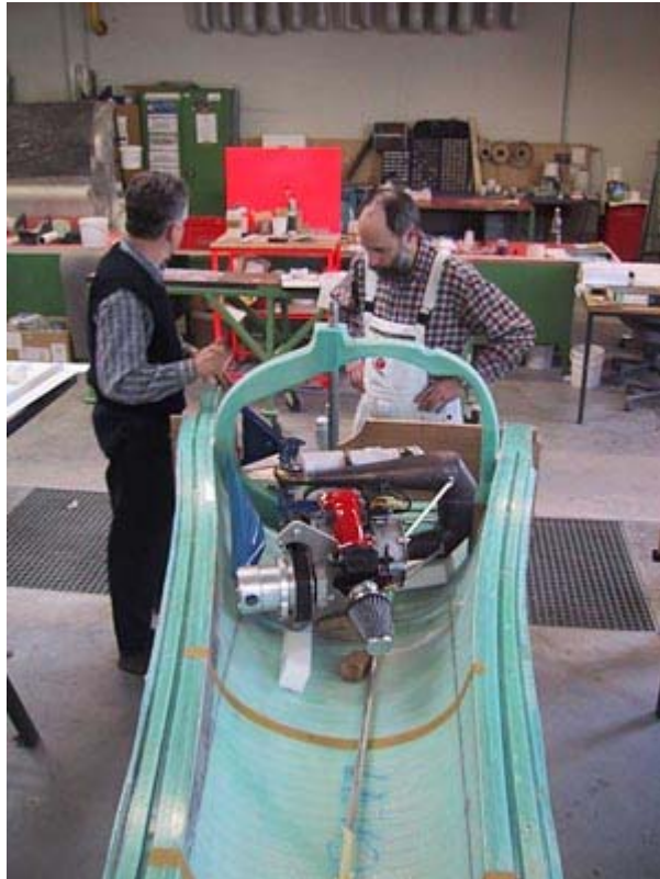
胴体のモデルに、パワープラントを取り付けているところ
